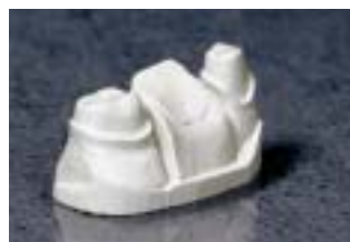
2 スペシャルプラスターにて耐火模型を製作。
